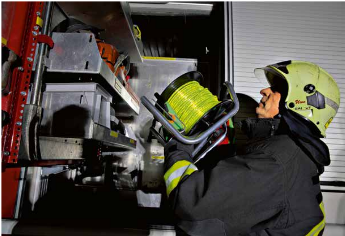
Пожежні машини зазвичай оснащені від одного до трьох кабельних барабанів.
