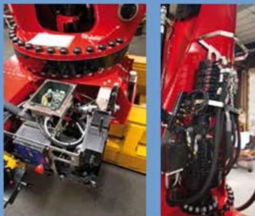
Кабель BIOFLEX 500-HF-TWIST с легкостью выдерживает вращения и изгибы, возникающие при работе крана
